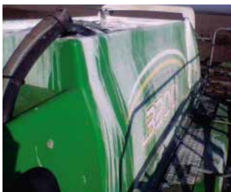
Problemas con sobrellenado de tanque.
